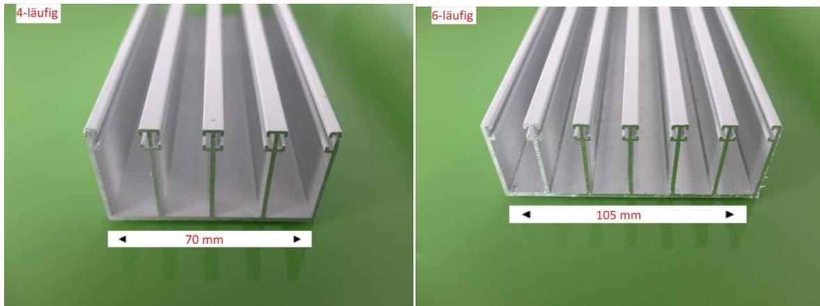
Die Oberschiene misst bei 4-läufiger Ausführung ca. 70mm breite, bei der 6-läufigen Ausführung ca. 105 mm breite.
